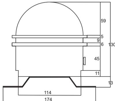
2 Montagelaschen 38x30mm, Ausfräsung für Bef.-Schrauben: 9,5x19 mm, seiti. Kabelausführung
