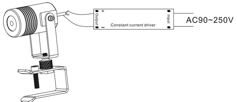
Anschluss mit Netzteil wie Abbildung,
