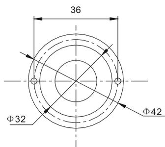
2 trous de montage  $\text{Ø}=3,5\text{mm}$ ,
