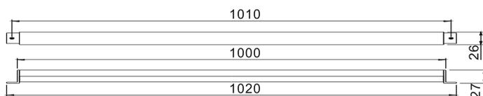
2 trous de montage  $\varnothing=4.0\text{mm}$
